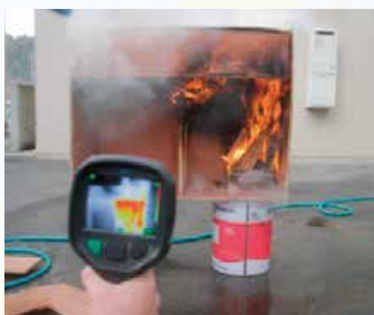
木製のボックスを作成し実際に火を点け、 火災の性状を知るための訓練です。
