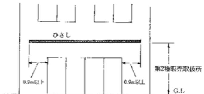
イ 第2種販売取扱所の上階の外壁が防火構造であり、かつ、例図3に示すとおり、当該販売取扱所の開口部の上端部から水平3m、高さ7mの範囲内における上階の開口部にはめごろしの防火設備を設ける。（S48 消防予第121号）
