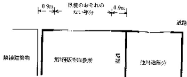
イ 第2種販売取扱所の外壁に、例図4に示すとおり、長さ0.9m以上の耐火構造の袖壁を設けた場合、隣接する建築物の外壁（建築物の第2種販売取扱所の用に供する部分以外の部分との間に設ける壁を含む。）から0.9m以内の部分であっても、「延焼のおそれのない部分」として取り扱うものとする。（S48 消防予第121号）
