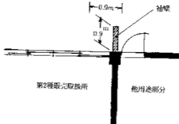
ウ 隔壁には、窓を設けないこと。ただし、防火管理のためにやむを得ないと認められる場合は、危政令第23条を適用して、必要最小限のはめごろし窓（鉄製枠の網入ガラス窓に温度ヒューズ付防火ダンパーを設けたものに限る。）を設けることができる。（S51 消防危第23-3号）
