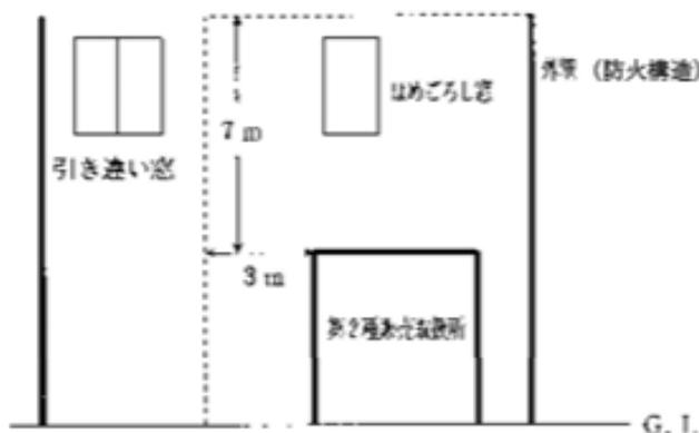
ウ 耐火構造又は骨組み及び下地を不燃材料で造ったベランダ等で、例図4に示すとおり上階の開口部を防火上有効に遮へいする。
