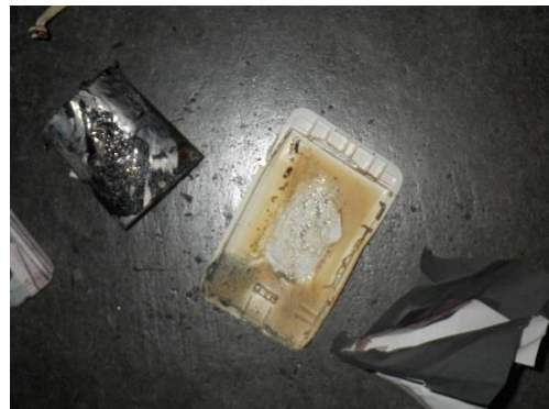
写真6 モバイルバッテリーの焼損状況
